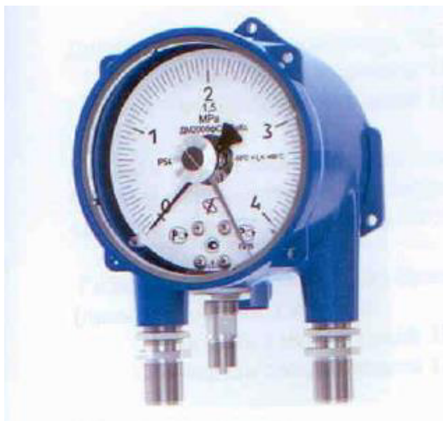
Манометр ДМ2005фCг1Exd с маркировкой 1Ex d [ia] ia ПВ Т4 Gb
